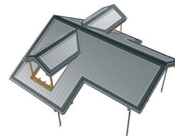
RYS. 9 Strefy narożne - szczególnie narażone na działanie wiatru
