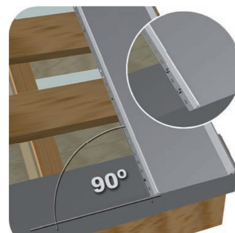
RYS. 12 Panele muszą być układane prostopadle do okapu. Przy okapie panel mocujemy dwoma wkrętami
