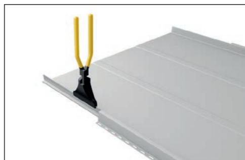
RYS. 22 Zamek wycinamy po obydwu stronach panela
