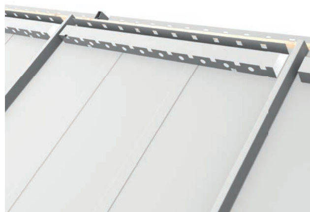
RYS. 31 Kalenice montowane są na listwie wentylacyjnej podkalenicowej. Długość listwy dostosowana do szerokości panela - 280 lub 480 mm
